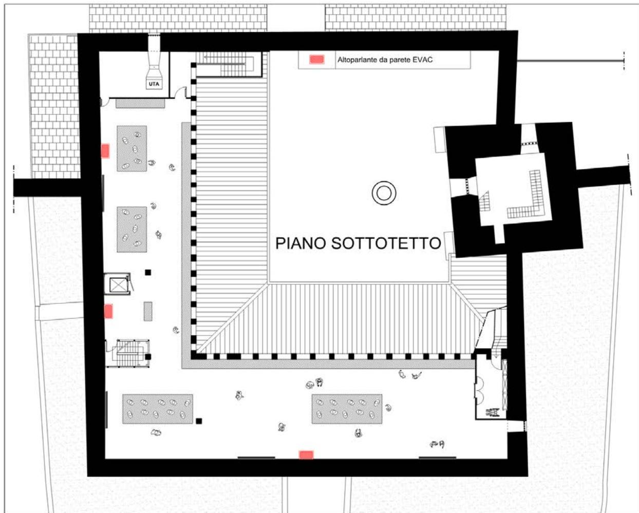
Schema di massima impianto EVAC piano sottotetto
