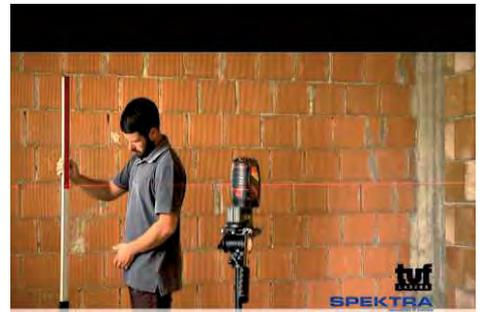
di verificare rapidamente la precisione del sottofondo
