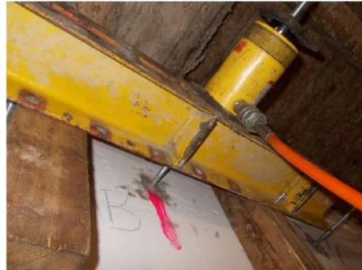
Le prove a strappo sono state condotte con l'ausilio di un martinetto cavo operante a spinta reazionato al muro retrostante. Le forze di contrasto all'estrazione sono state portate a distanza dall'area di estrazione mediante l'ausilio di una traversa metallica.
