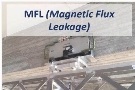
Si basa sull'effetto fisico per cui all'applicazione di un campo magnetico esterno, in corrispondenza di **fratture** o **interruzioni** sulla superficie di un componente, si formano ulteriori dipoli magnetici che creano un campo magnetico vagante vicino la superficie. Si verifica quindi una **variazione polare** nella **densità del flusso magnetico**. Un sistema di test magnetico è guidato sulla superficie del componente in calcestruzzo.
