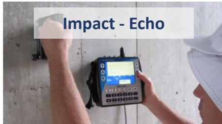
Si basa sull'analisi di **onde elastiche** generate dall'impatto di una sferetta di acciaio o di un martello sulla superficie della struttura in esame; queste onde di bassa frequenza (fino a 50 kHz), si propagano all'interno del materiale e sono riflesse da eventuali difetti e/o dalle superfici esterne.
