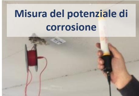
Si misura il **potenziale di corrosione** della struttura e mediante un elettrodo ausiliario esterno si invia una corrente in modo da determinare una piccola polarizzazione (inferiore a 50 mV). Il rapporto tra la polarizzazione e la densità di corrente che l'ha determinata è detta "resistenza di polarizzazione" ed è inversamente proporzionale alla velocità di corrosione.
