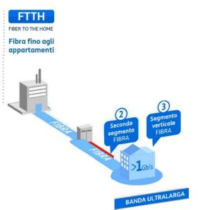
Nel caso di tecnologia di connettività di tipo FTTH, il cliente riceve in casa direttamente una connessione in fibra terminata su una presa ottica.
