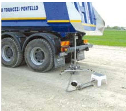
Figura 17 - Esecuzione prova su piastra
