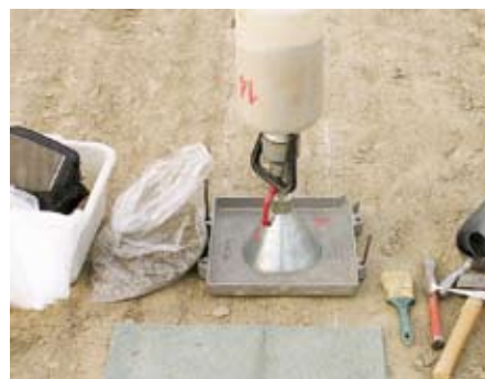
Figura 16 - Esecuzione prova per la determinazione densità in sito
