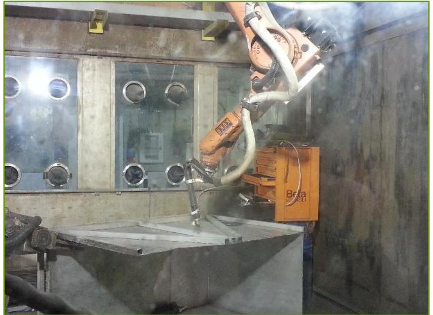
I grandi componenti sono ridotti di volume all'interno di celle dotate di manipolatori e dispositivi di taglio per consentire il confezionamento in contenitori da 200 l e il successivo invio agli impianti di trattamento.
