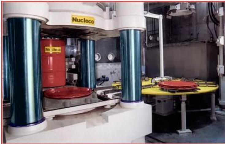
Compattazione del fusto e infustamento delle «pizze» in overpack
