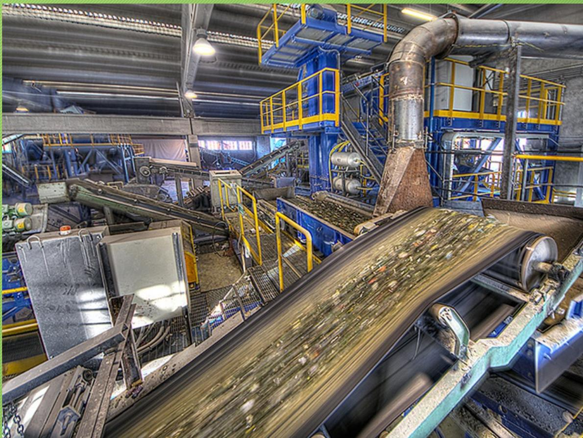
E' la prima fase delle operazioni di trattamento volta a separare i **materiali estranei, come ceramica ed altre frazioni di rifiuti**, dal flusso principale degli imballaggi in vetro. Tale operazione è condotta tramite operatori e componenti impiantistiche specifiche.
