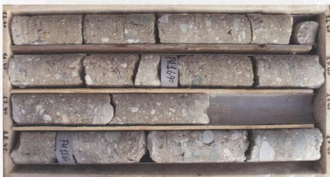
Fig. 33 - Campioni prelevati con carotiere T6S con diametro da 131 mm.
