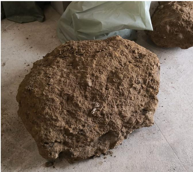
1. Estrazione campione su strato compactato dopo 7 gg di maturazione e immersione in acqua
