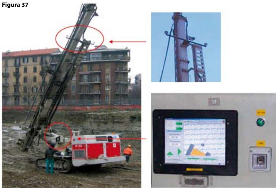
L'operatore ha sul monitor l'informazione della quota di inizio e fine trattamento, rilevata in tempo reale dal GPS, che dovrà impostare sul sistema di controllo di perforazione. In questo modo è possibile ottenere sempre, come detto, la quota esatta di trattamento indipendentemente dalla posizione in cui si trova il carro della macchina operatrice.
