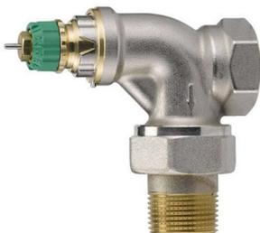
**CORPO** valvola termostatica per tubo ferro ad angolo e dritta con pre-regolazione di tipo dinamico, millimetrica della portata regolabile da 1 a 7 e massima portata in posizione “N”.
