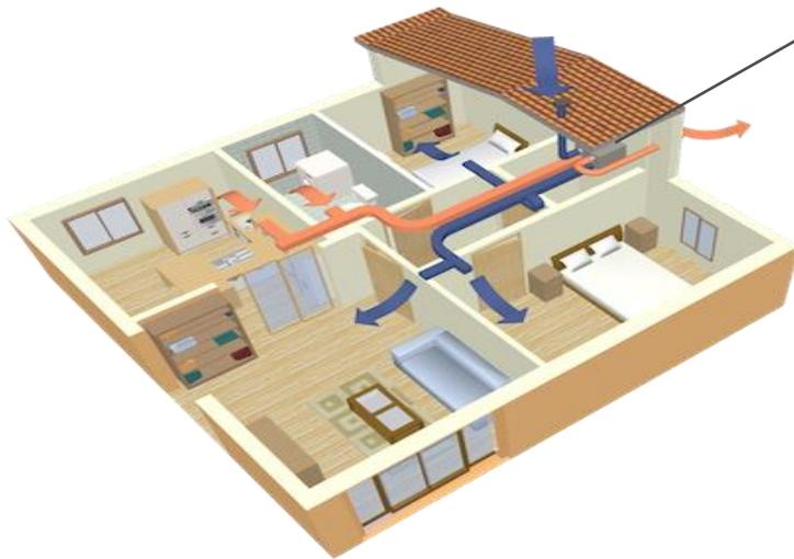
...il transito delle due correnti d'aria attraverso il recuperatore di calore permette di recuperare l'energia termica dell'aria esausta, altrimenti inutilmente dispersa.
