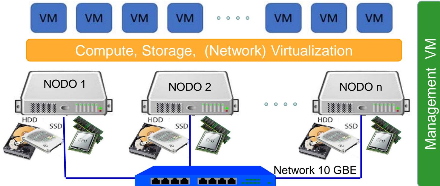
Necessità di una **comunicazione dedicata ad alta velocità** fra i nodi del cluster, per distribuire dati e metadati
