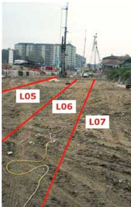
Figura 8 - Immagine stendimenti per rilievo
