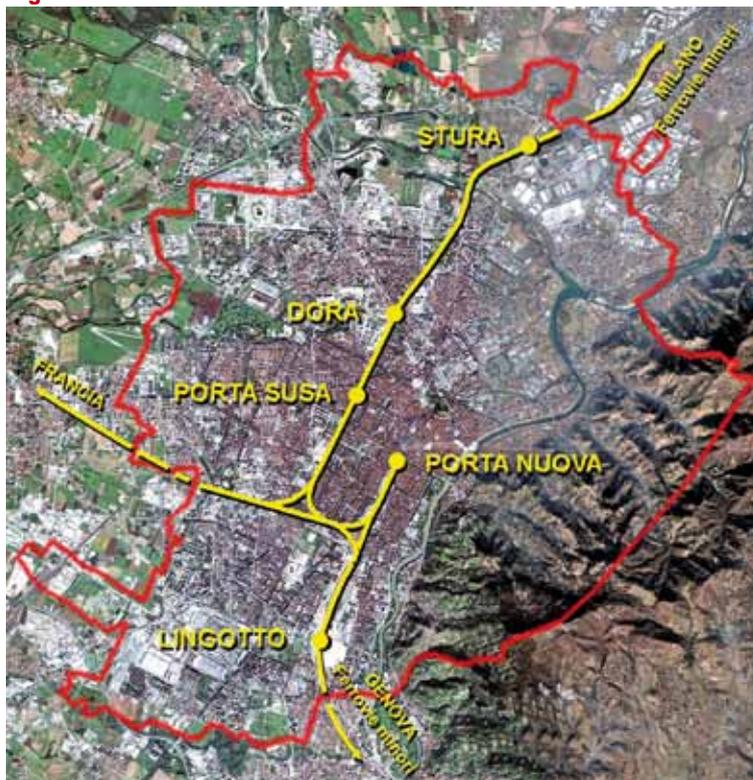
che il quadruplicamento dei binari tra la stazione di Porta Susa e quella di Stura. La necessità di eliminare la frattura determinata dai binari in città ha portato alla scelta di eseguire tutto il lavoro abbassando il piano del ferro, aggiungendo il concetto della riqualificazione urbana.
