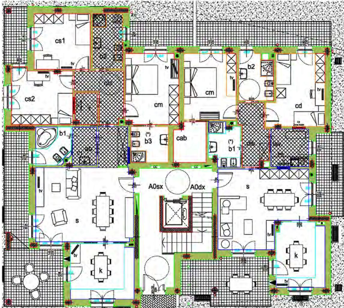
**Per ogni locale devono essere definite le aree pannellate, le aree pannellabili, il tipo di pavimento e il fabbisogno di potenza di progetto.**
