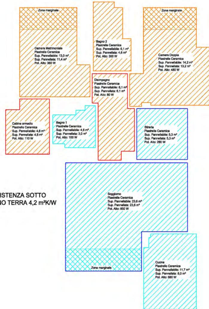
RESISTENZA SOTTO PIANO TERRA 4,2 m<sup>2</sup>/Kw
