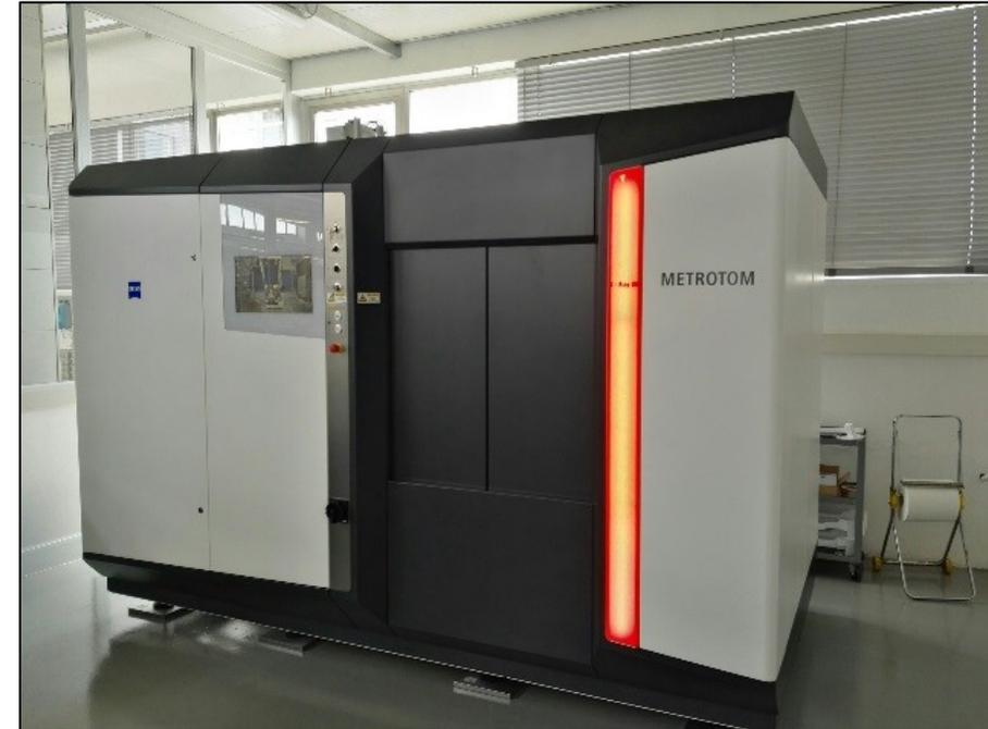
Tomografo: misurazione on line dei vuoti su un manufatto di materiale policarbonato o ABS
