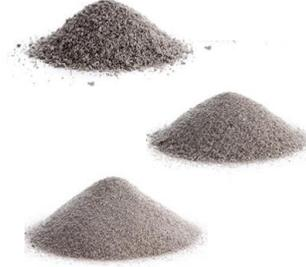
Figura 1 – Assortimento granulometrico miscela aggregati secondo SUPERPAVE
