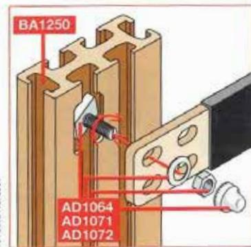
Una vite autobloccante a martello (M8) consente il fissaggio tra conduttori in qualsiasi posizione lungo la barra a profilo sagomato, garantendo un'ampia superficie di contatto.
