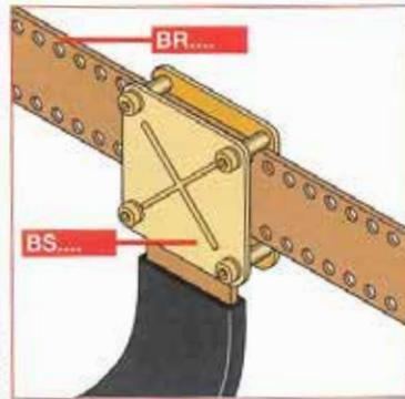
Derivazione tra barra piatta e barra flessibile tramite piastra di serraggio.
