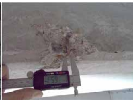
Determinazione copriferro e misurazione diametro barra
