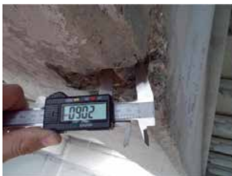
Determinazione copriferro e misurazione diametro barra
