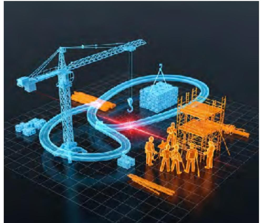
**Note:** "La clash detection non è una novità, ma l'IA la porta a un livello superiore. Non ci limitiamo a vedere se un tubo e una trave si scontrano nel modello finale. Qui simuliamo il cantiere nel tempo. L'IA prevede conflitti logistici e operativi, come il braccio di una gru che invade un'area di lavoro, permettendoci di
