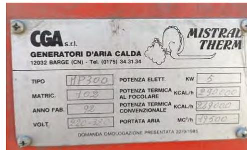
**Generatore aria calda a gasolio Pf 337 kW**
