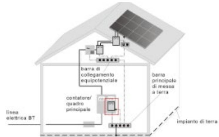
Figura 6-1 – Edificio e impianto FV senza LPS esterno
