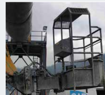
Strutture di protezione contro la caduta di gravi nelle PLE
