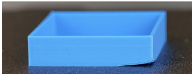
Esempio di warping di un componente prodotto tramite FFF.
