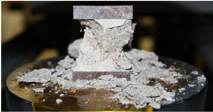
Esiti, rispettivamente, delle prove a flessione su tre punti e a compressione
