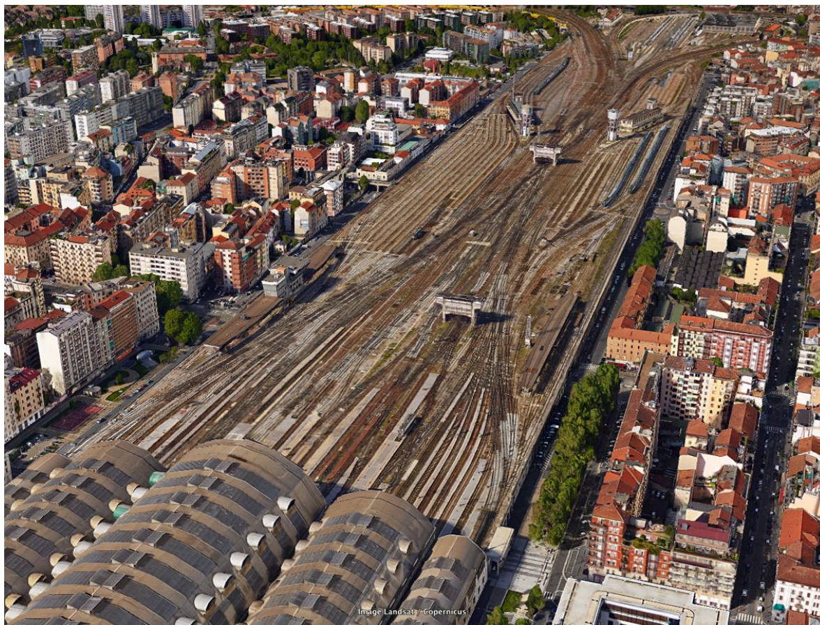
Vista aerea della Stazione Centrale, le cabine sono le due strutture a ponte sopra i binari; ai margini di una di esse sono visibili anche le due torri piezometriche
