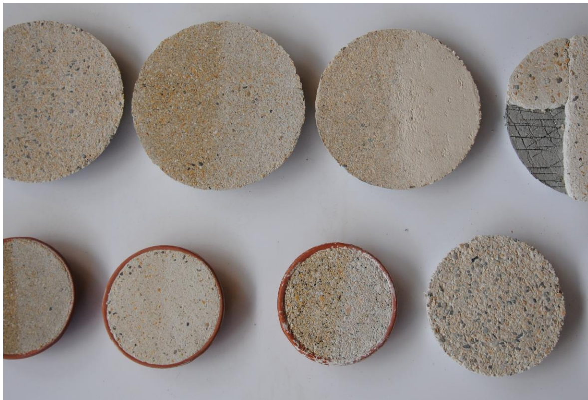
Alcune fasi dello studio granulometrico condotto in laboratorio a partire da campioni provenienti dal manufatto
