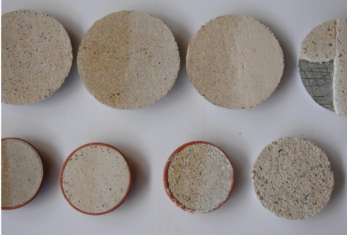
Alcune fasi dello studio granulometrico condotto in laboratorio su campioni del manufatto originale
