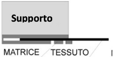
Scorrimento del tessuto e fessurazione dello strato di malta esterno
