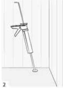
2 Iniezione dell'ancorante chimico nel foro
