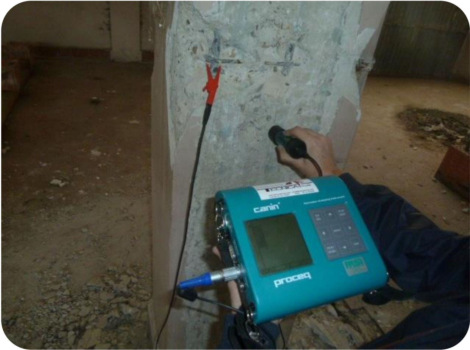
Mappatura del potenziale di corrosione
