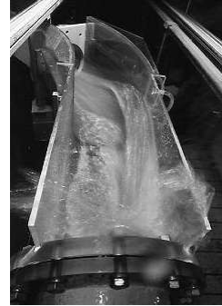
Vista da valle di un pozzetto di curva a 45°
