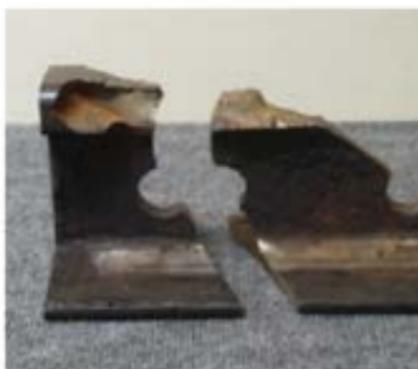
Fig. 1 Tipico caricamento di un giunto di estremità tra due binari. Quando una ruota passa, questa sollecita i bulloni e può causare cricche che partono dai fori. Pur non essendo questo il caso specifico per il disastro di Pioltello, tuttavia il caricamento a flessione del giunto in figura spiega perché il fishplate può fare da "coltello" per spaccare i 23 cm di pista di rotaia dal fianco
