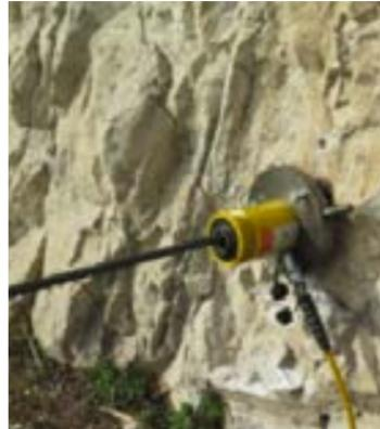
Prove di snervamento e rottura delle barre
