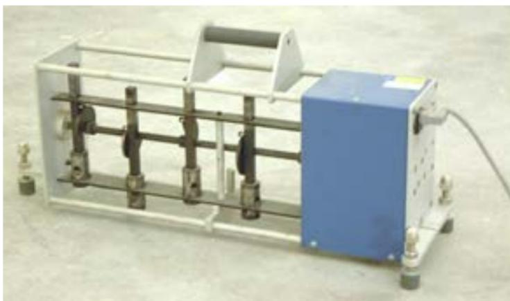
Figura 1 - La macchina del calpestio normalizzata UNI con martelli che cadono sul pavimento per verificare il requisito del D.P.C.M. 5/12/97 (foto di SP Technical Research Institute of Sweden)
