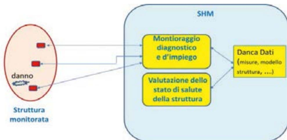
FIG 1. Schema operativo di un sistema SHM
