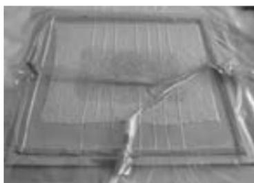
FIG 1 e 2. Realizzazione delle smart patch mediante sacco a vuoto (in alto) e smart patch finita (in basso)
