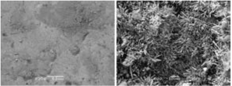
ACCIAIO ZINCATO. SX: Tubo nuovo (350X) DX: Tubo invecchiato 8 settimane (1000X).
