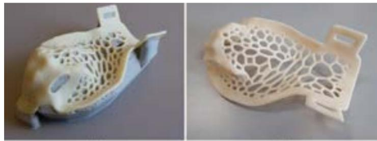
FIG 4. Ortesi finale stampata con manifattura additiva
