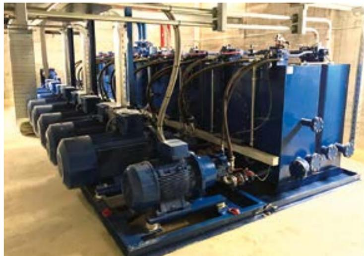
FIGURA 2. Centro di Ricerca L.E.D.A.: Centrale idraulica di potenza.
