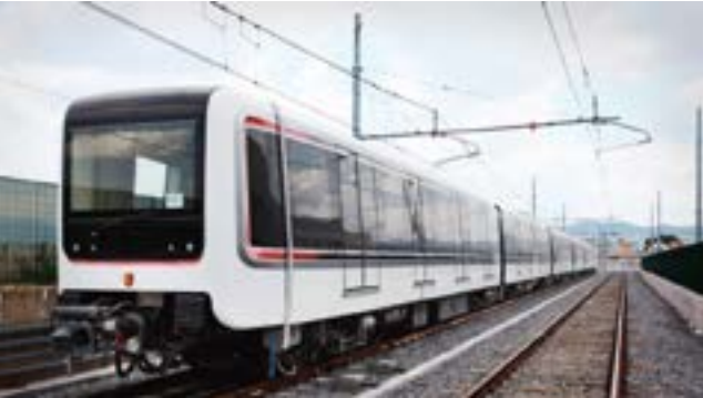
Foto 1. Treno Linea C: 6 carrozze intercomunicanti per una lunghezza pari a 109,4m capaci di trasportare 1200 persone. La capacità massima di trasporto è 24mila passeggeri all'ora per senso di marcia. La sicurezza è garantita non solo dalla videosorveglianza, ma anche dalle porte automatiche delle banchine. (© Metro C scpa)
