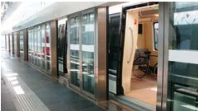
Foto 1. Treno Linea C: 6 carrozze intercomunicanti per una lunghezza pari a 109,4m capaci di trasportare 1200 persone. La capacità massima di trasporto è 24mila passeggeri all'ora per senso di marcia. La sicurezza è garantita non solo dalla videosorveglianza, ma anche dalle porte automatiche delle banchine. (© Metro C scpa)
