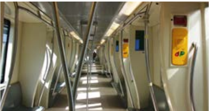
Foto 1. Treno Linea C: 6 carrozze intercomunicanti per una lunghezza pari a 109,4m capaci di trasportare 1200 persone. La capacità massima di trasporto è 24mila passeggeri all'ora per senso di marcia. La sicurezza è garantita non solo dalla videosorveglianza, ma anche dalle porte automatiche delle banchine. (© Metro C scpa)
