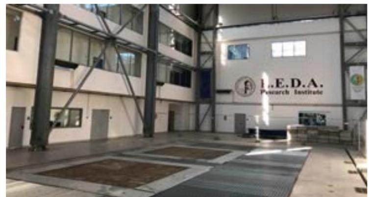
**FIGURA 5.** Sistema di due tavole vibranti.
