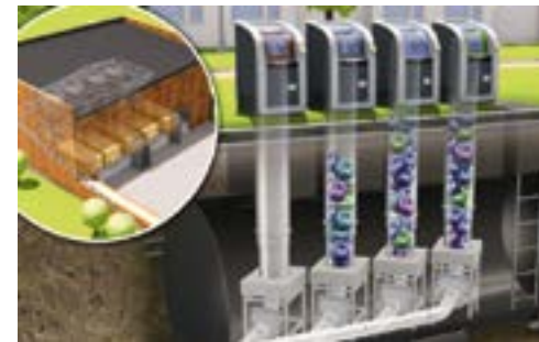
Fig. 5 - Colonne di accumulo dei rifiuti sotto le colonnine di raccolta stradale (Centro di raccolta finale - in alto a sx)
