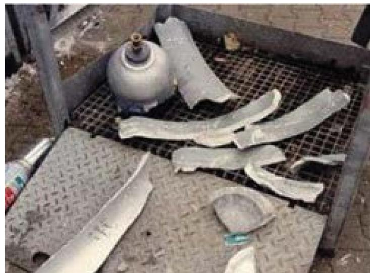
Figura 3. Esplosione di bombola di idrogeno
