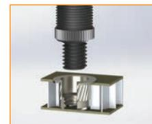
Accoppiare l'attrezzo di posa sull'inserto mediante avvitarlo
