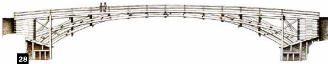
28 Ponte costruito nel 1809 sul Regnitz, in sostituzione di quello di muratura distrutto dalle piene del 1784, e progettato da Wiebeking ad una sola campata di 62,69 m.
