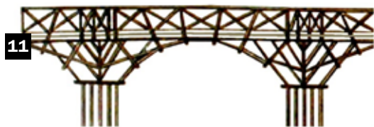
11. Ponte di Kingston sul Tamigi presso Londra, composto da sette campate, di cui quella centrale misurava 16,09 m di luce e le altre erano variabili da 9,07 m a 13,00 m.
