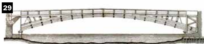
29 Ponte costruito nel 1809 sul Regnitz, di cui alla precedente figura. Sezione longitudinale con rappresentazione del controventamento di irrigidimento trasversale ottenuto per mezzo di croci di S. Andrea.
