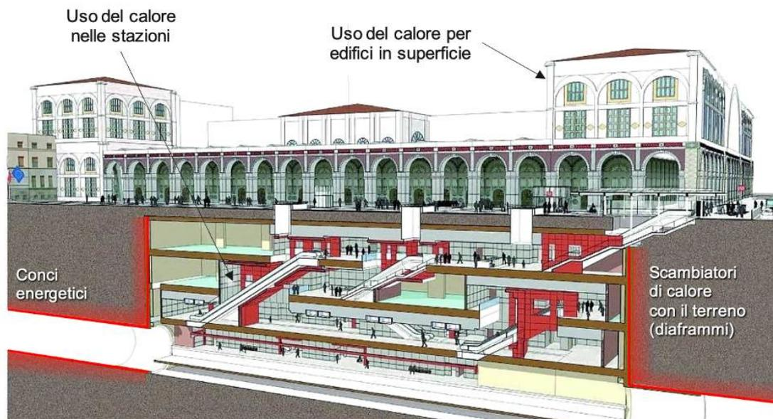
Figura 3 - Schema concettuale dell'utilizzo del calore estratto tramite gli scambiatori geotermici integrati nei diaframmi e nei conci prefabbricati della galleria e delle stazioni della linea 2 della metropolitana di Torino.
