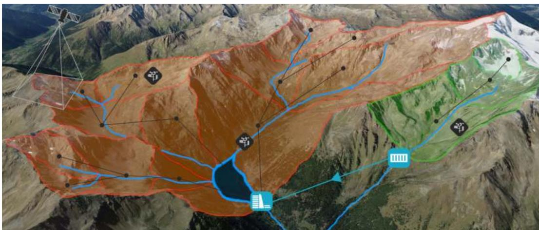
**Figura 1** - Esempio di un Digital Twin applicato ad un bacino idrografico montano composto da una diga (area arancione) e un bacino allacciato (area verde). In loco sono poste tre stazioni meteorologiche, l'opera di presa e il monitoraggio da satellite. Credits: Waterjade Srl.
