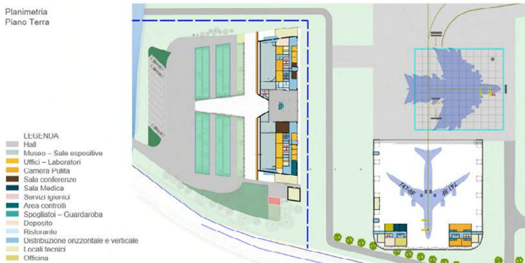
Figura 6 - Planimetria dell'hangar e dell'edificio polifunzionale dello spaziorporto di Grottaglie. La distribuzione funzionale degli spazi è rappresentata mediante l'uso di colori differenziati, corrispondenti alle diverse destinazioni d'uso indicate nella legenda inclusa.
