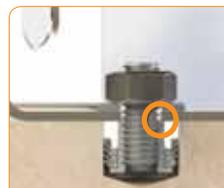
Per una corretta applicazione si raccomanda che il perno sia avvitato su tutto il tratto utile di filetto e che l'elemento da fissare sia a contatto con la boccia metallica dell'inserto Keep-Nut®.
